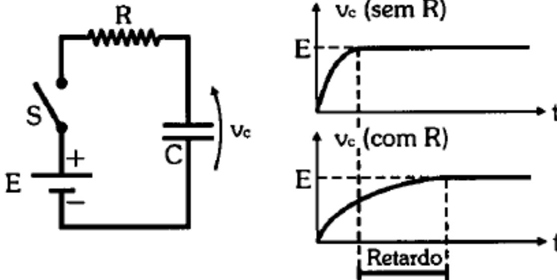
Ligando um resistor em série com o capacitor, pode-se retardar o tempo de carga, fazendo com que a tensão entre os seus terminais cresça mais lentamente.
